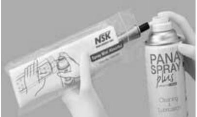
Смазка производится любым многофункциональным смазочным спреем для стоматологических наконечников. Смазывайте наконечник в течение 1-2 секунд перед каждой стерилизацией в автоклаве.
