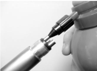
Смазка производится любым многофункциональным смазочным спреем для стоматологических наконечников. Смазывайте наконечник в течение 1-2 секунд перед каждой стерилизацией в автоклаве.
