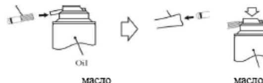
Смазка производится любым многофункциональным смазочным спреем для стоматологических наконечников. Смазывайте наконечник в течение 1-2 секунд перед каждой стерилизацией в автоклаве.
