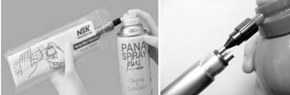
Смазка производится любым многофункциональным смазочным спреем для стоматологических наконечников.
