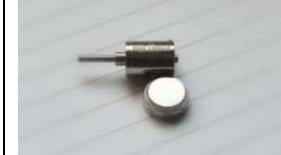
Открутите кнопку с помощью ключа и вытащите картридж в углубление головки и нажмите на него. Закрутите кнопку руками, затем затяните ключом.
