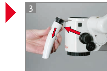
3 Нажмите кнопку и отсоедините втулку рукоятки.
