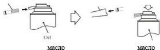
Смазка производится любым многофункциональным смазочным спреем для стоматологических наконечников. Смазывайте наконечник в течение 1-2 секунд перед каждой стерилизацией в автоклаве. Процедура смазки: Встряхните баллон 3-5 раз. Затем вставьте насадку в наконечник до упора и распыляйте спрей в течение 1-2 секунд.
