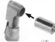
Вставьте новый картридж в головку наконечника, которая должна быть немного приподнята, чтобы деталь совпала с желобом внутри передней части головки, для обеспечения правильного крепления.
