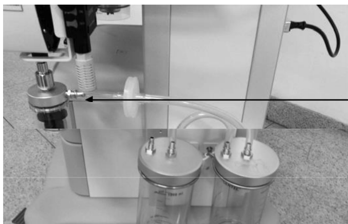
Вставьте отсасывающую трубку в разъем защиты от переполнения
