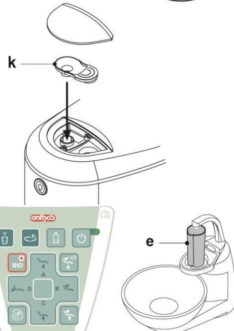
**Опорожнение гидравлического контура системы W.H.E.**
