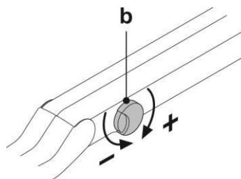
**Устройство остановки пружинных рычажков возврата инструментов (только вариант исполнения со шнуром с верхней подачей).**
