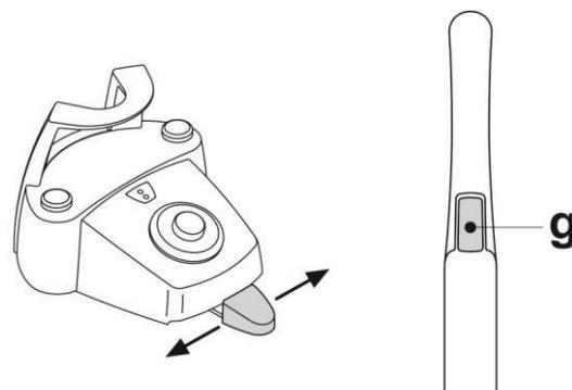
**Включение системы освещения камеры.**
