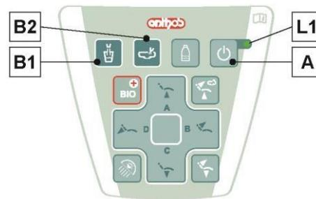
**Изменение режима автоматического механизма подачи воды на пневмательнице путем вызова «ПОЛОЖЕНИЯ ОПОЛАСКИВАНИЯ» кресла.**
