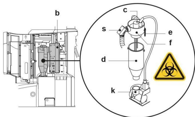
**9.6. ОЧИСТКА ФИЛЬТРА ВОЗВРАТНОГО ВОЗДУХА ТУРБИНЫ**
