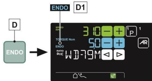
**Выбор рабочих программ микромотора (только для консоли с сенсорным ЖК-дисплеем).**
