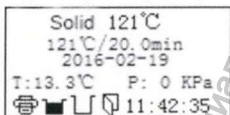
Рис. 7 – Внешний вид главного экрана стерилизаторов паровых «Armed» DGT-8B, DGT-12B, DGT-18B
