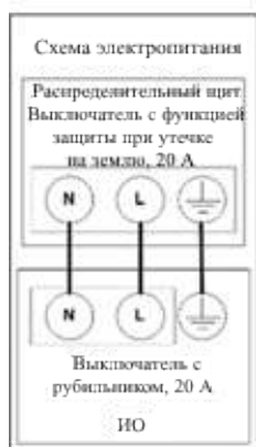
Центральный пульт распределения с размыкателем цепи
