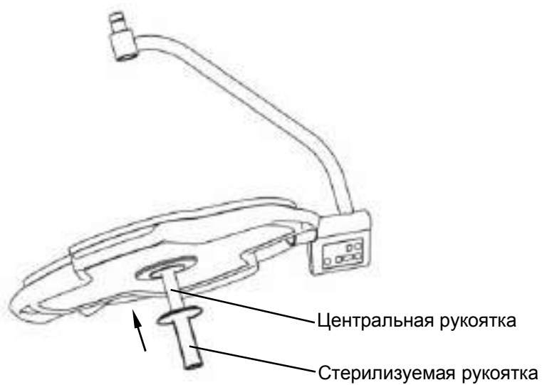
Рисунок 2-3. Установка стерилизуемой рукоятки
