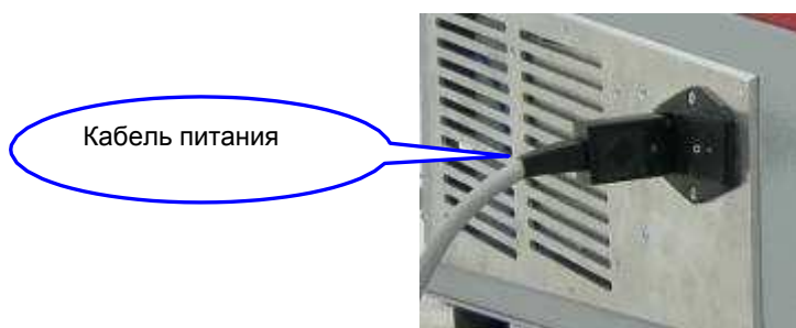
Рисунок 9: Подключение кабеля питания
