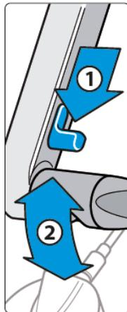
(2) Более точной регулировки положения головки лампы можно добиться путем ослабления или затягивания винта.
