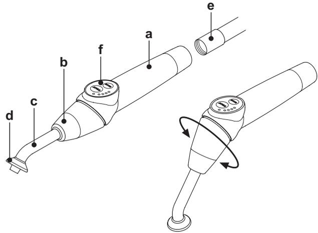
**ПРИМЕЧАНИЕ:** полимеризационная лампа может быть использована в различных конфигурациях (палочка, пистолет или любое промежуточное положение), чтобы облегчить работу пользователя.
