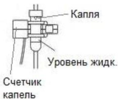
Рисунок 11. Схема установки счетчика капель
