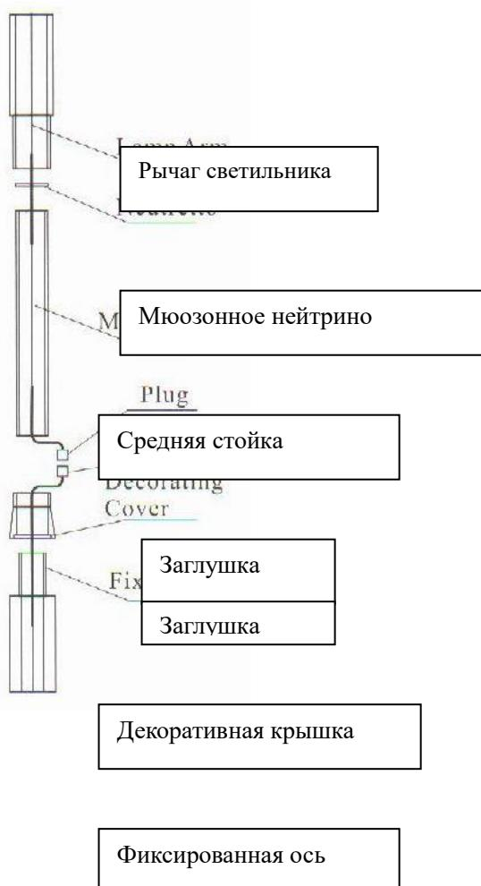
4.2 Вытащите рабочее освещение, вставьте фиксированную ось в отверстие переднего рычага светильника и закрутите его болтами M5x12.
