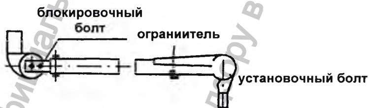
Рис. 12 Установка балансирующего узла
