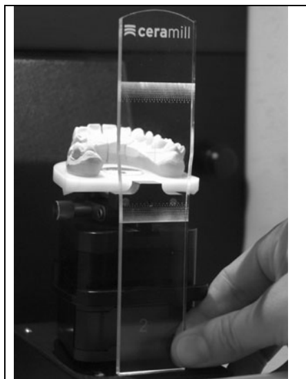
Bild 19 Anwendung der Messbereichsschablone
