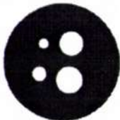
Рис. 2.5. Разъем «Сименс» (4 отверстия)
