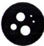
Рис. 2.8. Разъем «Мидвест LUX 5 Pin»
