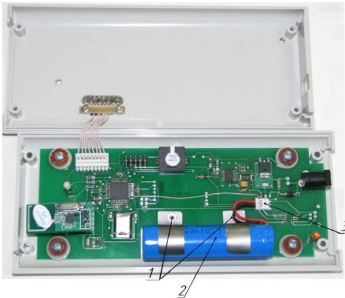
1 – Гайки крепления 2 – Аккумуляторная батарея 3 – Штекер Рисунок А.17 – Замена аккумуляторной батареи
