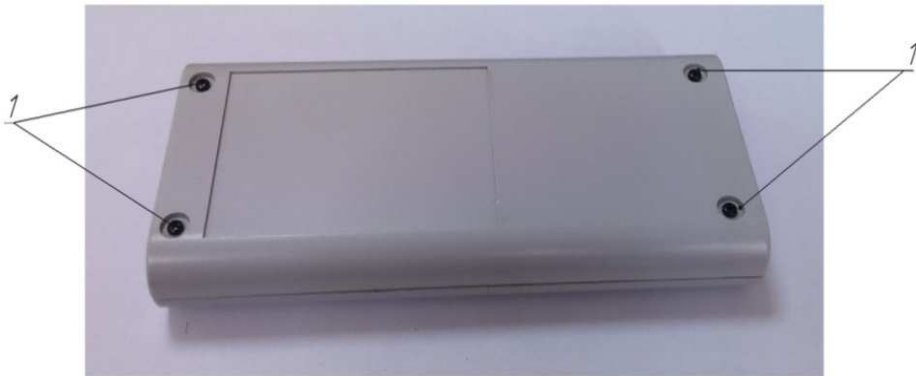
1 – Винты крепления задней панели корпуса пульта Рисунок А.16 – Задняя панель корпуса пульта управления видеокамерой
