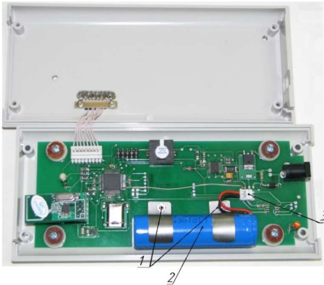
Рисунок А.30 – Задняя панель корпуса пульта управления видеокамерой
