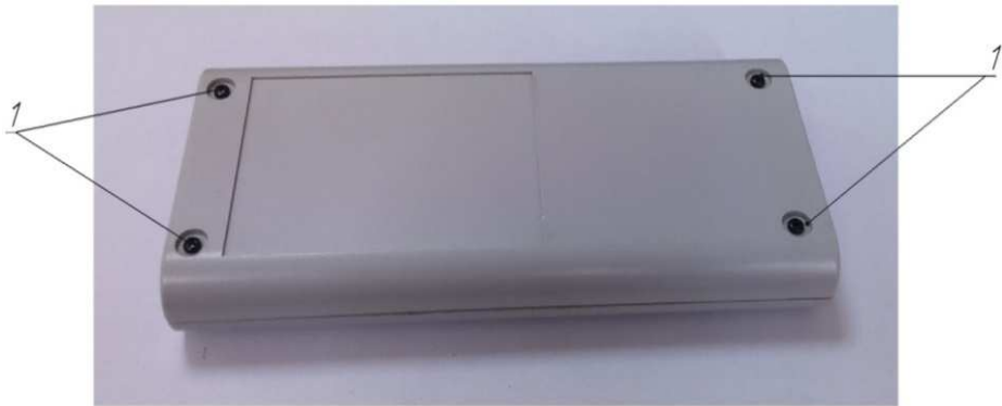
1 – Винты крепления задней панели корпуса пульта
